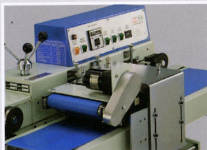
皮帶式壓風裝置，在封口前將袋內空氣壓出。
